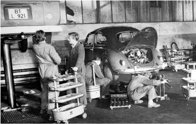
Ende der 60er Jahre wurden – wie hier bei Motor-Nützel in Bayreuth – ein Bremsenprüfstand, eine Vermessungsbühne und die ersten Hebebühnen eingebaut. Bis zu diesem Zeitpunkt konnten die Monteure die Reparaturen an den Fahrzeugen nur im Liegen ausführen.
