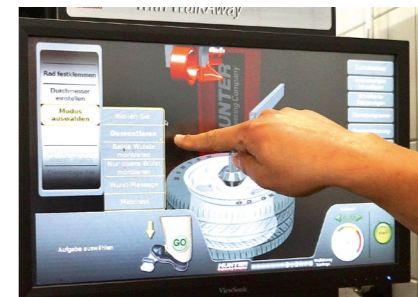
Intuitive Touchscreen-Steuerung: Jeder Arbeitsschritt wird genau vorgegeben und muss bestätigt werden.
