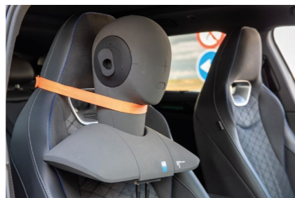
Ein Kunstkopf nimmt die Störgeräusche im Fahrzeug bis ins Detail auf.
