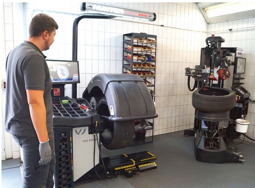
Die Teilautomatisierung macht es möglich: Der Monteur wuchtet das Rad, während das nächste bereits montiert wird.
