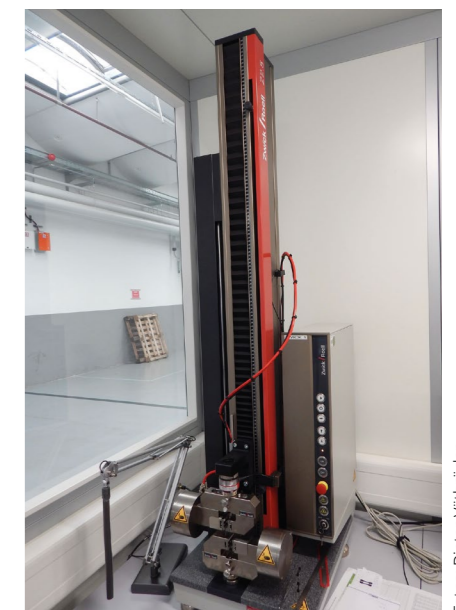
Zerreißprobe: In der Zugmaschine wird die Zugfestigkeit der Materialien getestet.
