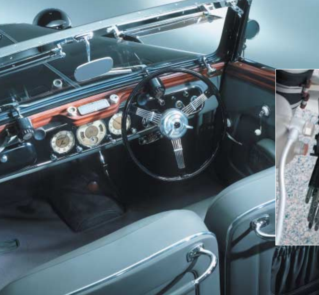
Vorwählgetriebe (im Maybach SW 38): Gangwahl mechanisch am Lenkrad, Gangwechsel durch pneumatische Betätigung nach Gaswegnahme
