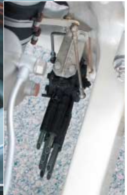
Vorwählgetriebe (im Maybach SW 38): Gangwahl mechanisch am Lenkrad, Gangwechsel durch pneumatische Betätigung nach Gaswegnahme
